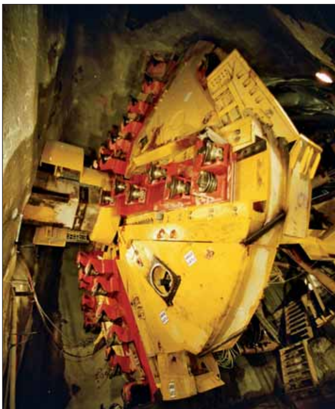
Obr. 5 Řezná hlava rozšiřovacího tunelovacího stroje TBE Fig. 5 The TBE boring head
